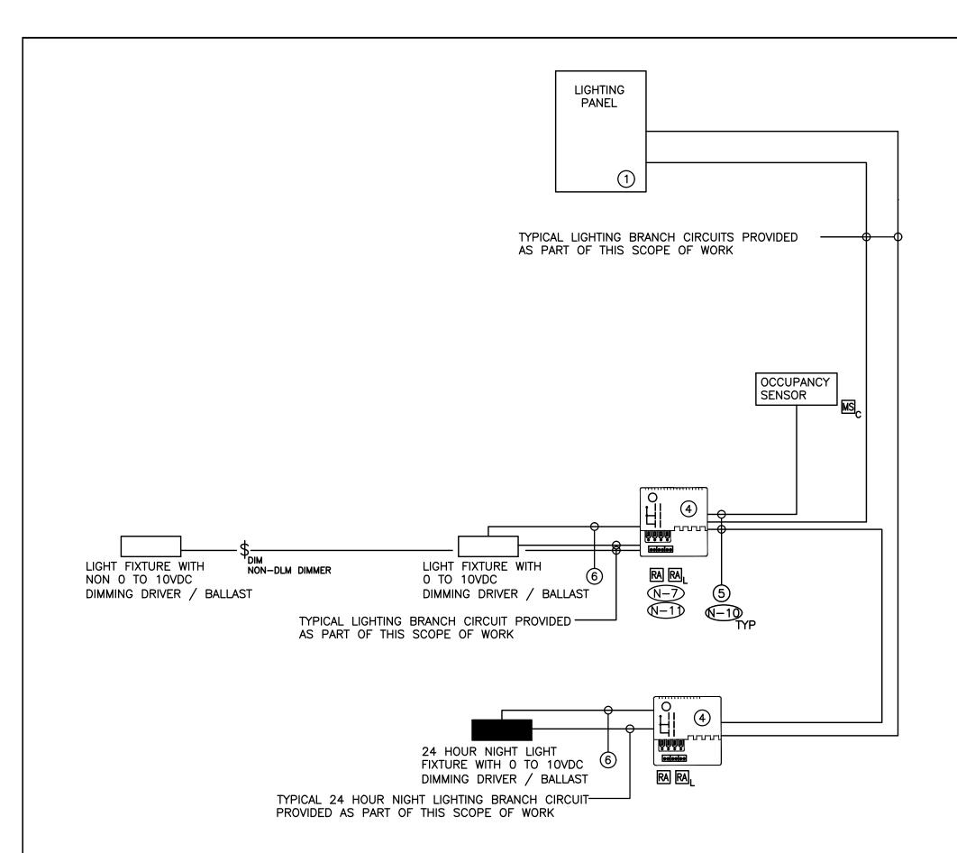
LOW VOLTAGE LIGHTING CONTROL SYSTEM WIRING SCHEMATIC
